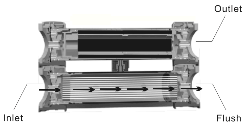
Obr. 3 Princip proplachu UF membrány
