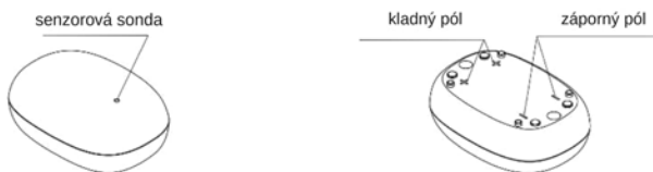
Senzorová sonda a kontakty pro párování – kladný a záporný pól na spodní straně senzoru.
